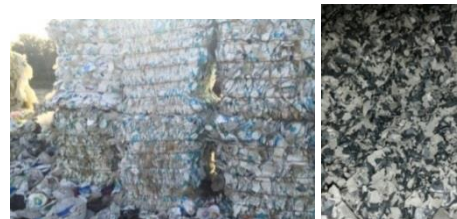
Photographies 1 et 2. Paillettes de PET opaque testées dans la fabrication de mousses PET
