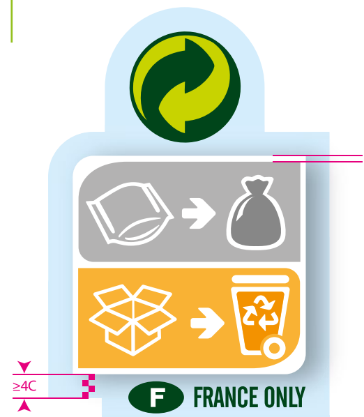
construction cartouche sous le Point Vert
